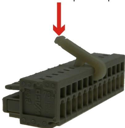
V případě ztráty háčku je možné použít i tenký plochý 2mm šroubovák, který se zasune do horního otvoru. Mírným tlakem směrem dovnitř dojde k odklopení zámku pro kabeláž. V případě malého odklopení je možné mírným nadzvednutím šroubováku zámek odklopit více.
