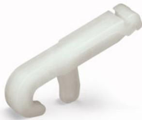
Háček se zahákne do horního otvoru, který je umístěn nad zámky pro kabeláž. Následně se tlakem na háček směrem dolů odklopí zámek pro kabeláž a zasune se odizolovaný kabel.
